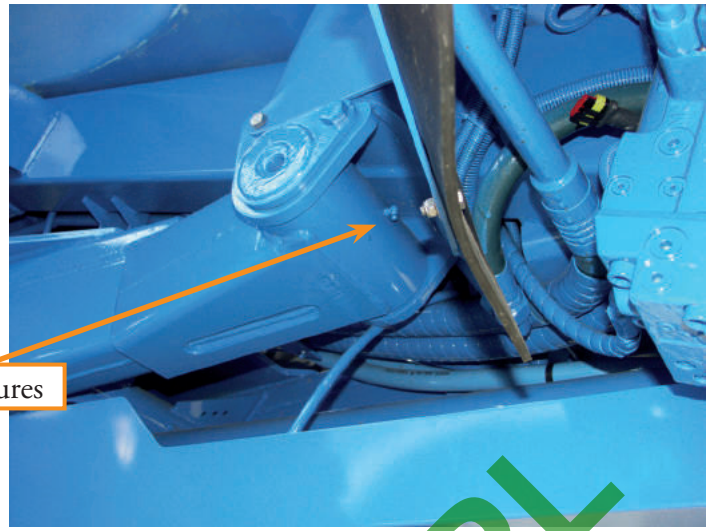
Articulation du berceau de suspension avant
